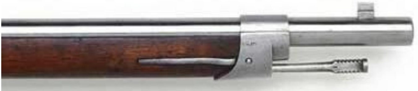
De landmacht/koloniale loopmond: in dit geval heeft de pompstok geen sleuf voor de poetslap.
